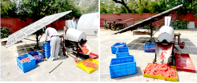
सौर शक्ति से चलने वाले सब्जियों (टमाटर) के बीज निकालने वाला यंत्र
