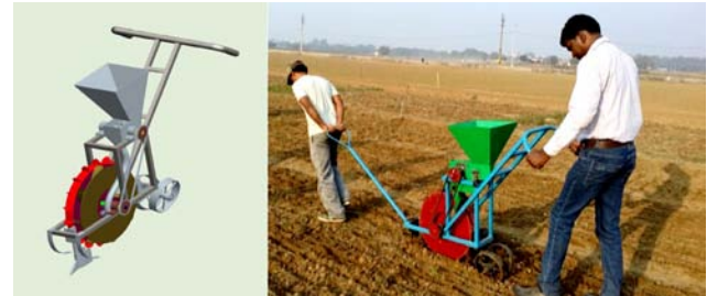
सीधी बीजाई के लिए एक सटीक धान रोपाई यंत्र का 3D मॉडल (बाएं) और फ़ैल्ड में इस यंत्र का उपयोग (दाएं)।
